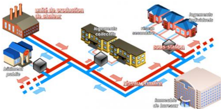
Figure 13 : Principe de fonctionnement d'un réseau de chaleur
