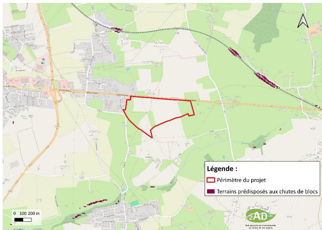
Figure 19 : Terrains prédisposés aux chutes de blocs
